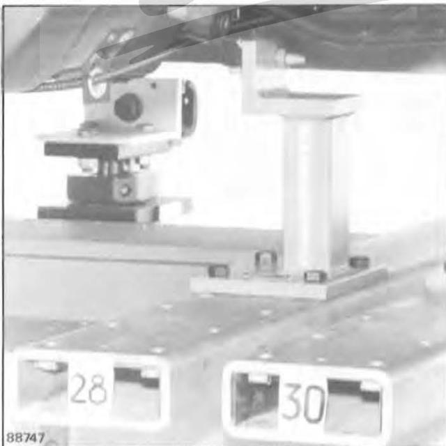
Ermöglicht die Kontrolle der vorderen Befestigungspunkte der unteren Querlenker hinten, ohne daß der Motor ausgebaut werden muß.
