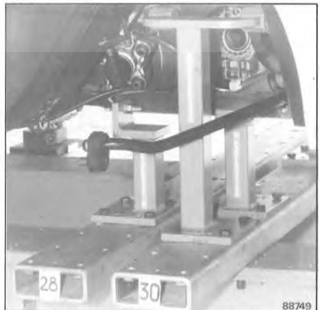
Ermöglicht die Kontrolle der Befestigungspunkte des oberen Querlenkers der Hinterachse am Motortragrahmen, ohne daß der Motor ausgebaut werden muß.
