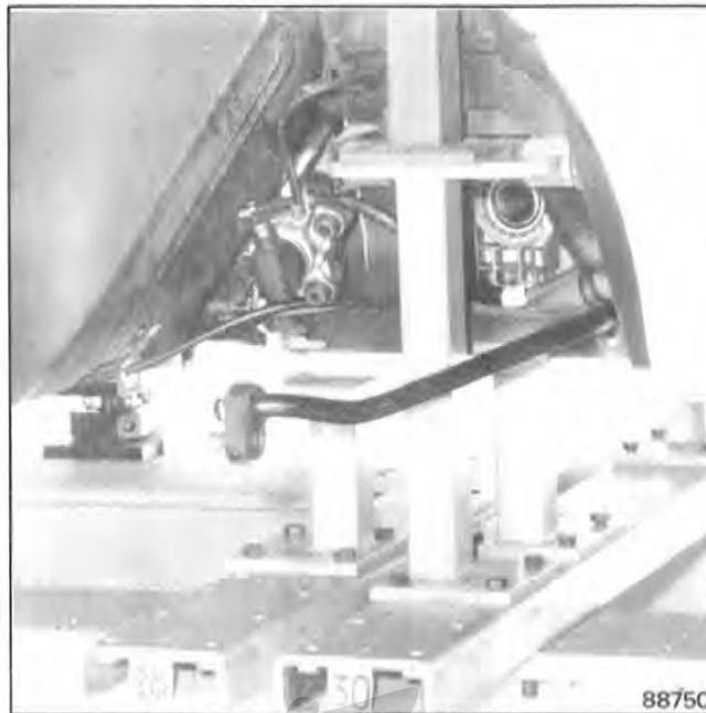
Ergänzt den Aufsatzbock zur Befestigung des oberen Querlenkers; der Motor wird nicht ausgebaut.
