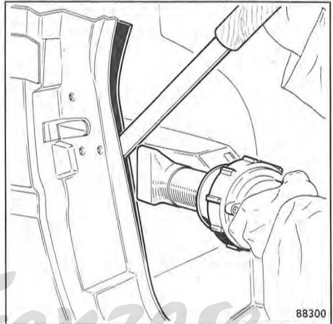
Das beschädigte Teil erwärmen und nach und nach mit Hilfe eines Werkzeuges eigener Herstellung, das wie ein Hebel angesetzt wird, lösen.
